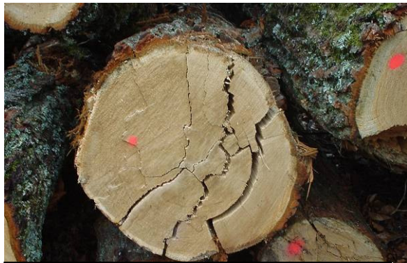
Gesplittert / lange Risse → nicht erlaubt
